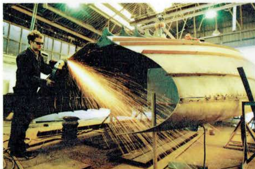
Mekon hat sich auf den Bau von Rundspantjachten konzentriert und stellt die Rumpfe aus vorgeschrittenen Platten mit wenigen Fachleuten her
